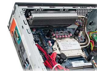
Système de refroidissement par caloduc
